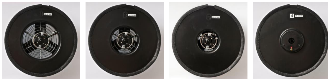
Fig. 4.16 : Ventilateur DuctBlaster B avec anneau 1, anneau 2, anneau 3 et anneau 4
