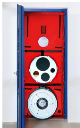
Fig. 3.2 : Plaque d'orifice Field check et ventilateur BlowerDoor Standard installés sur site
