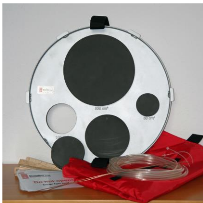
Fig. 3.1 : Accessoires recommandés pour la vérification de l'étalonnage sur site
